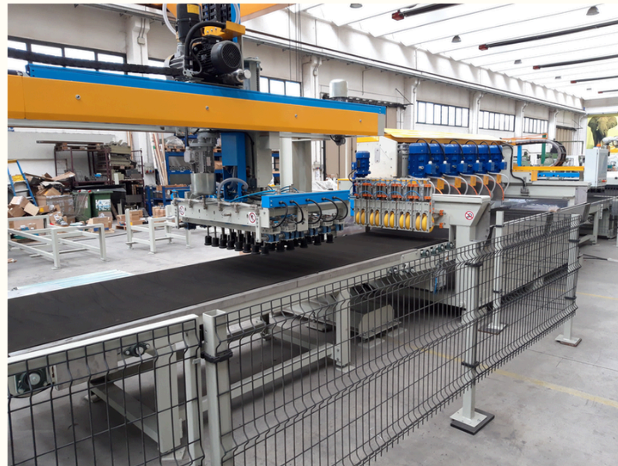
PPVF PALLETTIZZATORE A PORTALE CON VENTOSA PER FILAGNE GANTRY PALLETIZER WITH VACUUM HANDLING DEVICE FOR STRIPS
