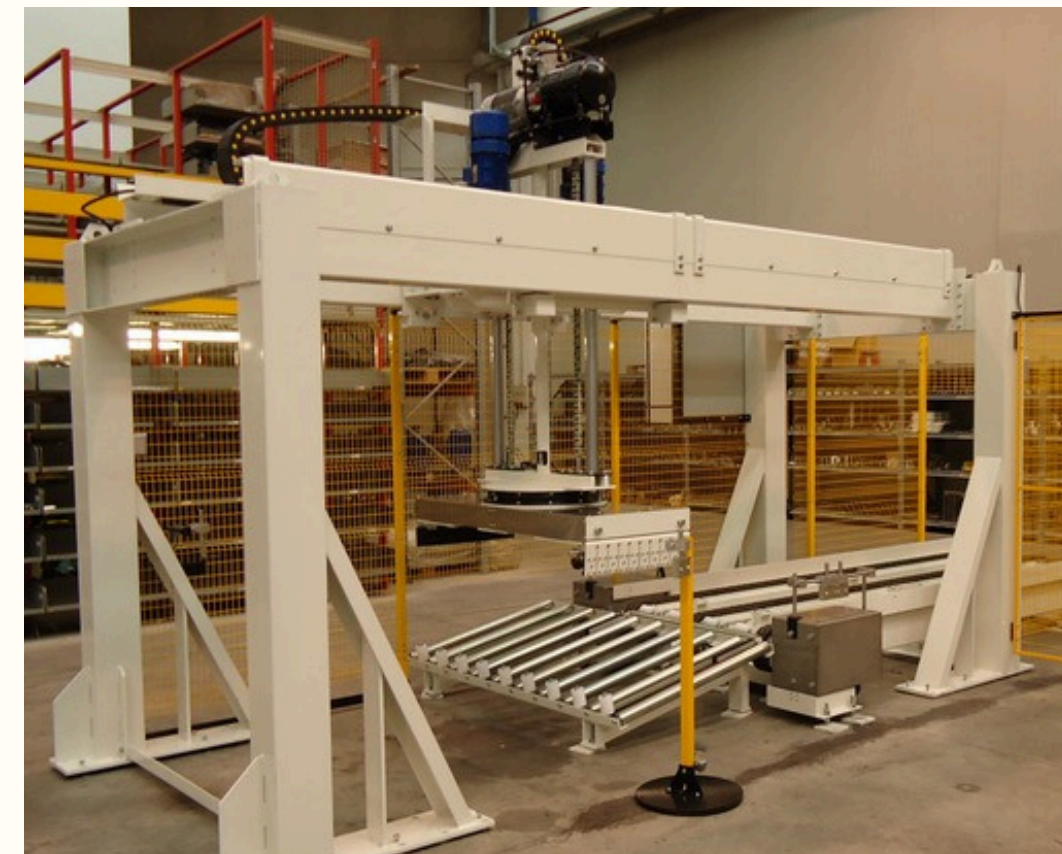
PPM PALLETTIZZATORE A PORTALE CON PINZA GANTRY PALLETIZER WITH CLAMP
