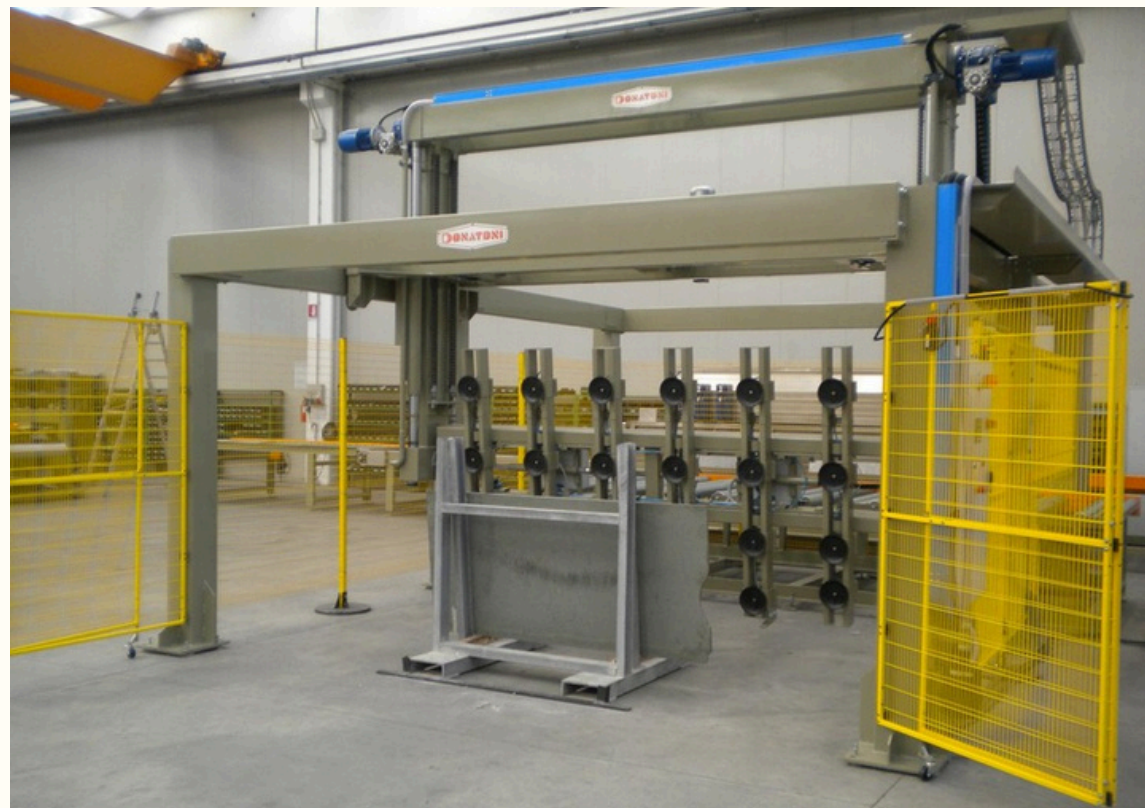
PPVL PALLETTIZZATORE A PORTALE CON VENTOSA PER LASTRE GANTRY PALLETIZER WITH VACUUM HANDLING DEVICE FOR SLABS
